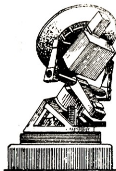
Rys. 2. Radioteleskop z reflektorem i parabolicznym do odbioru radiopromieniowania Słońca
